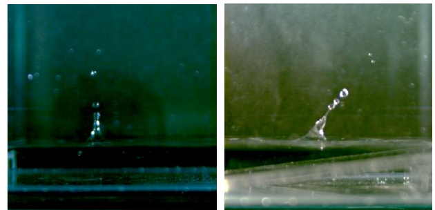
Fig.2 水平な底(左)と傾斜のある底(右)によるスプラッシュ
